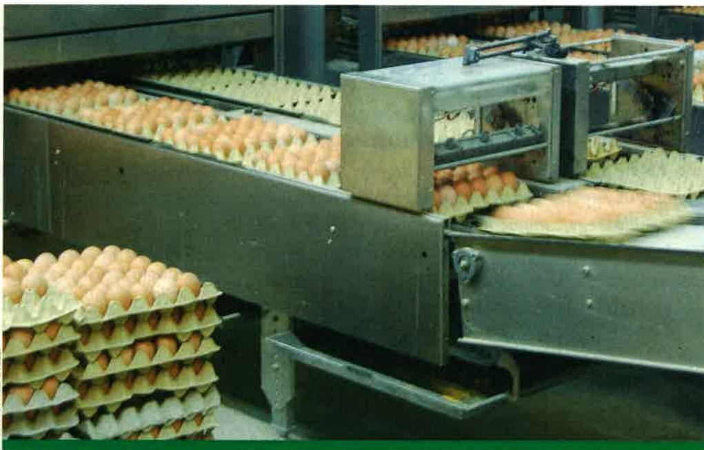
Óránként 60 ezer tojást válogat az automatikus berendezés
